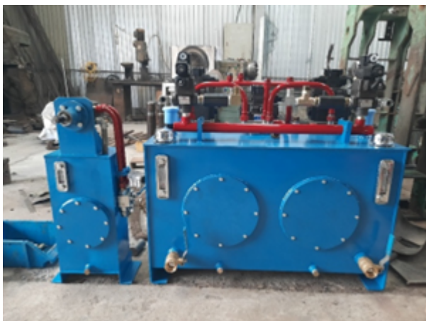
Trạm nguồn thủy lực
